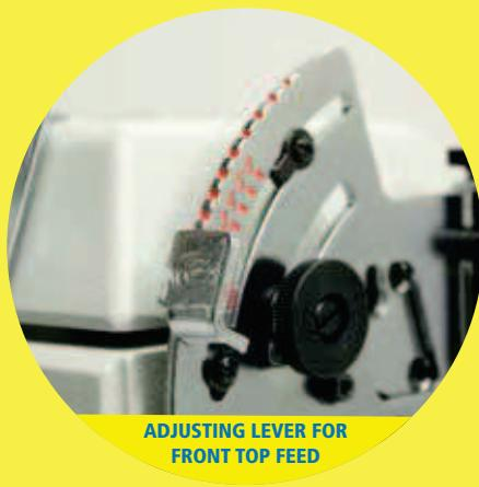
ADJUSTING LEVER FOR FRONT TOP FEED
