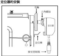
將定位器安裝於手輪心軸突出處並將定位器底 部凹槽對準車頭上的定位棒,位置調好後將定 位器轉子上的兩顆六角螺絲鎖好,最後將定位 器插頭接至控制箱的定位器插座
